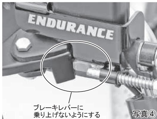
5. ブレーキレバーを少し強めに握り、本商品のシャフトを奥まで押し込んだ状態でレバーを離すとフロントブレーキがロックした状態になります。またその状態からレバーを握るとスプリングの力でシャフトが戻り、ロックが解除されます。
