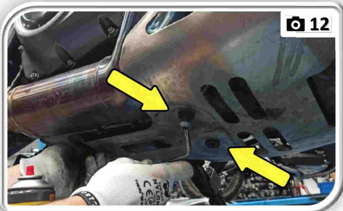
**IT** Svitare le viti inferiori della protezione motore.
