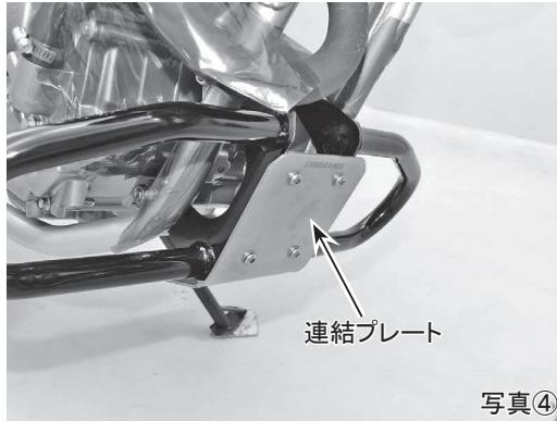
5. 全体のバランスを調整して、各ボルト、ナットを規定トルクで締め付けます。
