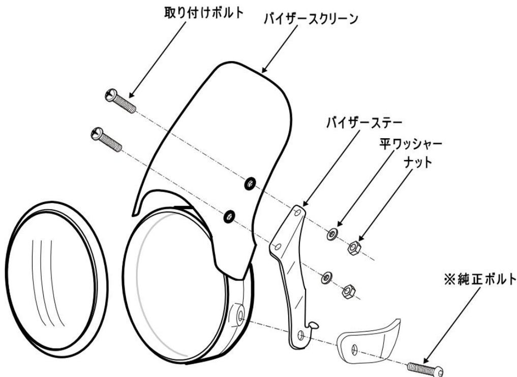
2: ヘッドライトレンズを取り外し、ヘッドライトを固定しているステーの純正ボルト (M8又はM10/左右各1本) を緩めます。
