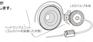
③車輌側コネクターとコントローラー側平型端子に付属のH7カプラーを接続し、 点灯確認を行ってください。
