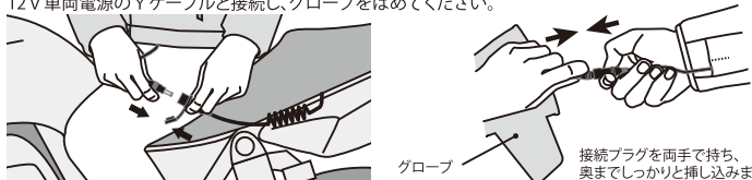
グローブ 接続プラグを両手で持ち、奥までしっかりと挿し込みます。
