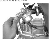
4.スロットルハウジングのビスを抜き取りス ロットルケーブルを抜き取り、スロットル ケーブルを交換ます。
