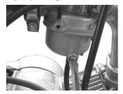
2.フューエルチューブ、スロットルバルブを キャブレターから取り外しスロットルバル ブとスロットルケーブルを分離します。
