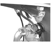
3.エアークリーナーコネクティングチューブ のバンドを緩め、インレットパイプ固定ボ ルトを抜き取りキャブレターをインレット パイプ付きで取り外します。
