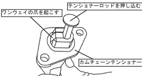
◇付属のガスケットとカムチェーンテンショナーをボルト/ワッシャ2本でシリンダーに取り付ける。
