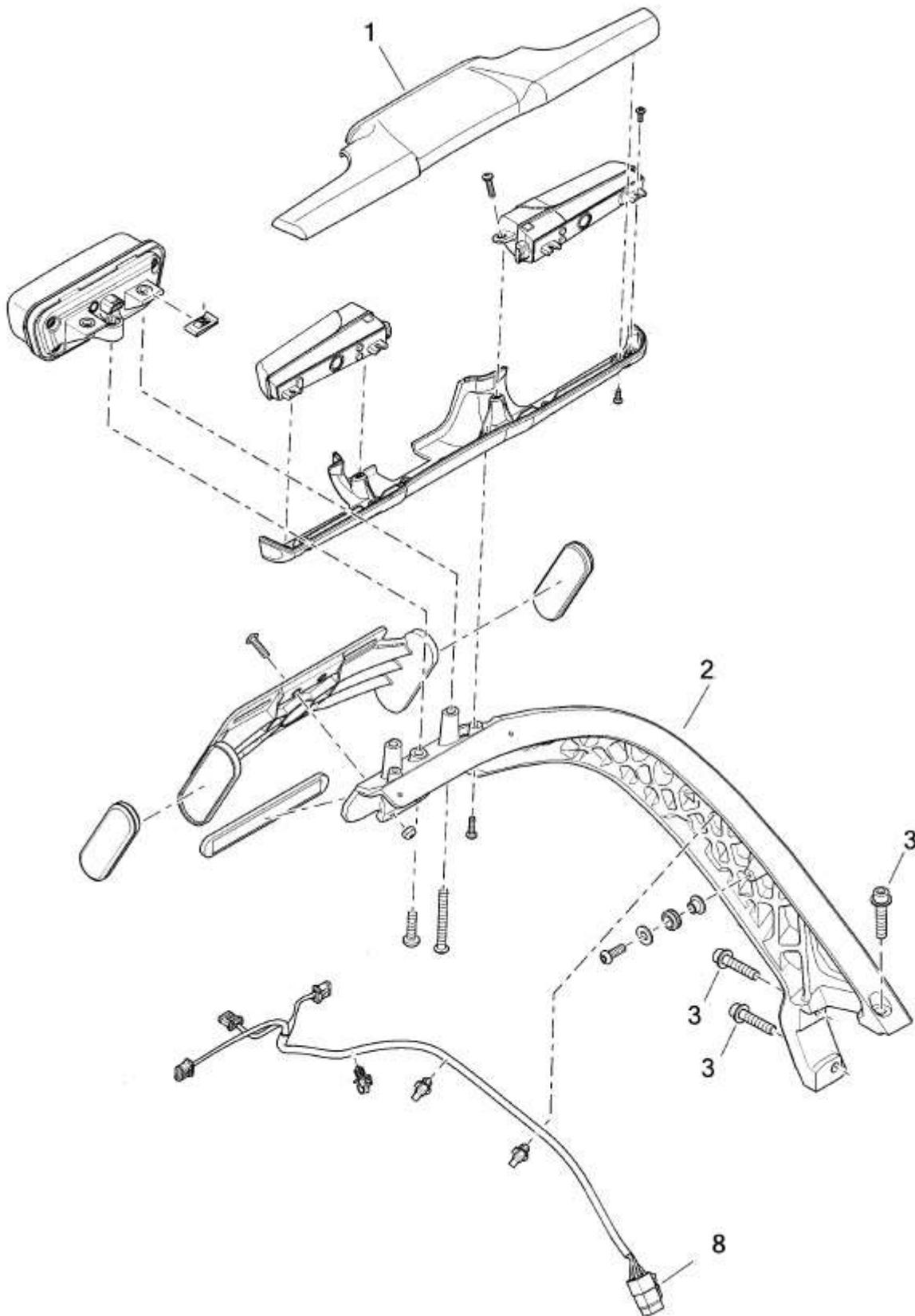
Demontieren Sie die hintere Beleuchtung (1), den inneren Kotflügel und den seitlich befestigten Träger (2). Lösen Sie dazu die Schrauben (3) und die Steckverbindung (8).
