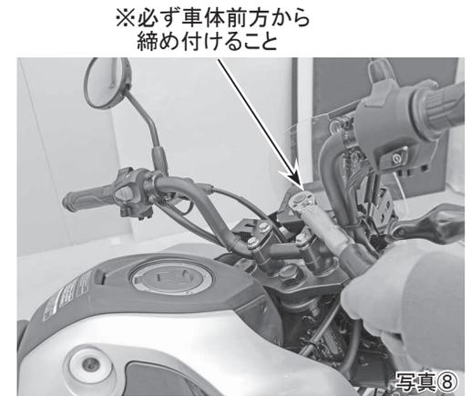
9. 各部のクリアランスや干渉がないかを確認し、ボルトの締め付けを確認して、問題なければ完成です。
