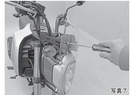
8. 各部の位置出し、調整が終わったら、前項3. および4. で仮止めしたM8ボルトを必ず前方のボルトから本締めします。
