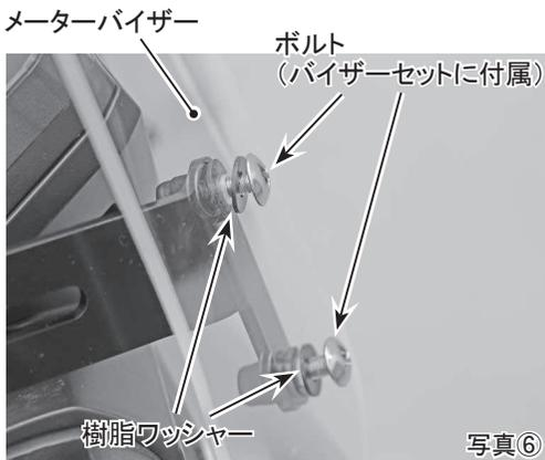
7. 前項6で仮止めしたメーターバイザーのボルトを本締めしていきます。このとき、4本のビスは均等に少しずつ数回に分けて締めてください。(写真⑦)
