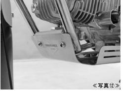
12. 各部のボルト、ナットを締め付ける前にハンドルを左右にいっぱいまで動かしフロントパイプと車両ステム部等とが干渉しないように調整します。(写真⑬)
