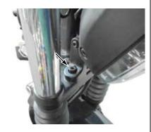
○⑤⑥ L. 及び R. ブラケットをセットし、 ウインカーを止めていたノーマルの端付きボルト (ウインカーボルト)を仮取り付けします。
