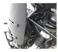
○各部との隙間等を確認しながら、仮取り付け した各スクリューを規定トルクにて締め付け ます。
