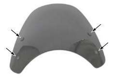
○④フランジボタンヘッドソケットスクリュー 5x15 4個を使用し、⑤⑥ブラケットに ①バイザーを仮取り付けます。
