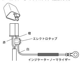
3. イジケーターノーマライザーを図の破線の様にフレーム裏側に沿って這わせて、丸アース端子をシートブラケットのスクリューで共締めし、収縮チューブの両端あたりを結束パンドでフレームに固定します。
