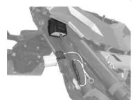
2. 純正のリレーハーネス橙色コードに、キット付属のインジケーター ノーマライザーをエレクトロタップで接続します。
