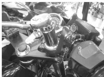
4. トップブリッジ割り締めボルト、ステアリングステム割り締めボルトを緩めてフォークパイプを回転させて左右のイニシャルアジャスターのマーキングを揃えます。
