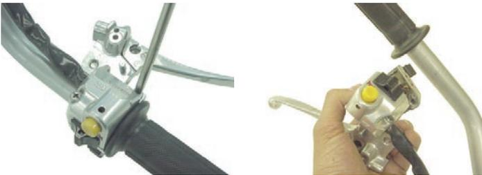
3. レバーホルダー②③④の中から車両に適した物を選び、スプリングピンを差し込んでクラッチレバー ASSY. に取り付けます。
