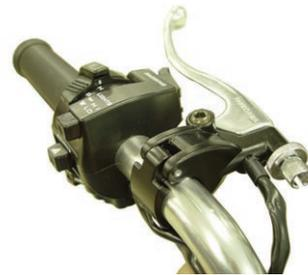
5. クラッチレバー ASSY. にキット内の⑥クラッチケーブル COMP. を取り付け、純正のクラッチケーブルの取り回しを参考に車体に取り付けて下さい。(取り回し方法がわかれば純正のクラッチケーブルは取り外して下さい)。
