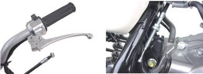
2. ウィンカースイッチハウジング下側のスクリー2本を外して、スイッチハウジングを分割します。ハンドルパイプのワイヤーバンドを外し、コードをライトケースより引き出して、スイッチを取り外します。
