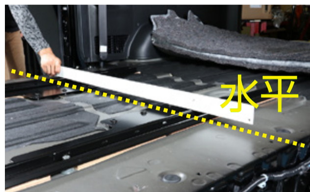
■ 右レール外側から左レール内側の寸法が右写真の様に最前部～最高部までが、幅800mmになるように微調整して下さい。 又、右レール外側・内側、左レール内側・外側の頂点が水平になる様にも調整して下さい。水平調整には付属されているワッシャー等をレールの下に入れて調整して下さい。レールのスムーズな動きを得る為に左右のレールが並行且つ水平になる様に微調整することがポイントとなります。
