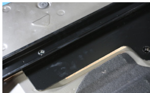
■ レールに付いているプレートを内側にしてスライドレール左右を純正ボルトで仮固定して下さい。
