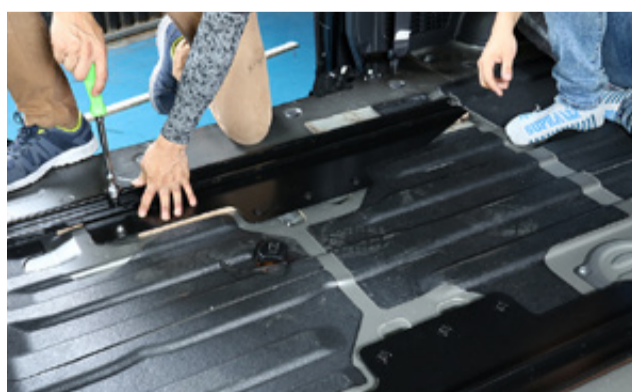
■ 調整が終われば全てのボルトを固定して下さい。 増し締めの際に先程の手順で調整した『幅』がズれる可能性がありますので十分、気をつけて下さい。
