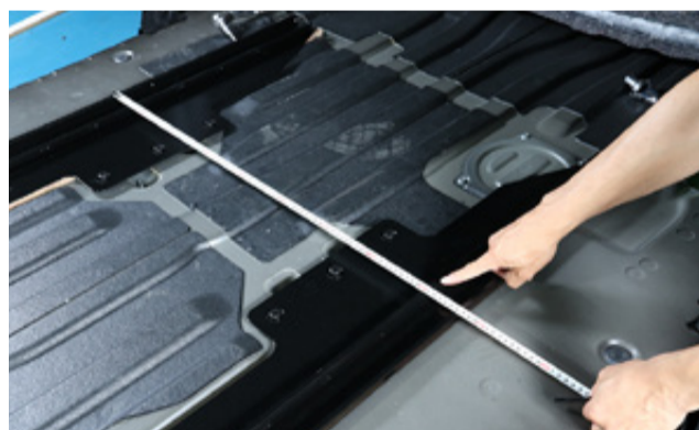
■ 右レール外側から左レール内側の寸法が右写真の様に最前部～最高部までが、幅800mmになるように微調整して下さい。 又、右レール外側・内側、左レール内側・外側の頂点が水平になる様にも調整して下さい。水平調整には付属されているワッシャー等をレールの下に入れて調整して下さい。レールのスムーズな動きを得る為に左右のレールが並行且つ水平になる様に微調整することがポイントとなります。
