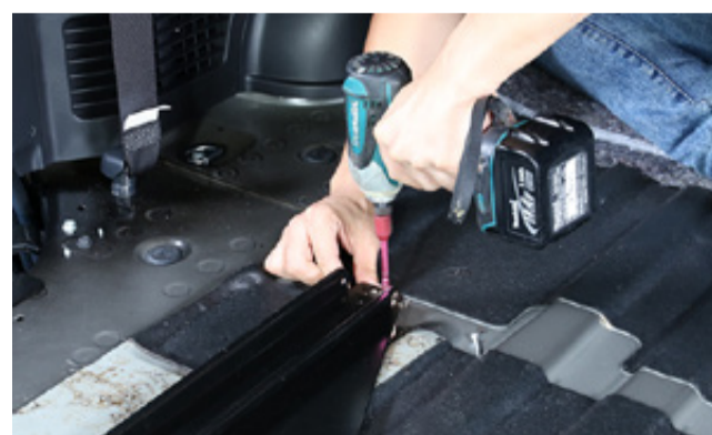
■ レールの最後部は付属の先端部ドリルネジでフロアに固定して下さい。
