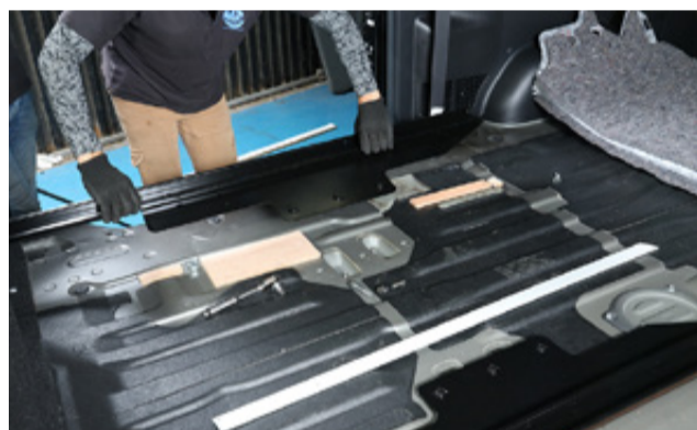
■ レールに付いているプレートを内側にしてスライドレール左右を純正ボルトで仮固定して下さい。
