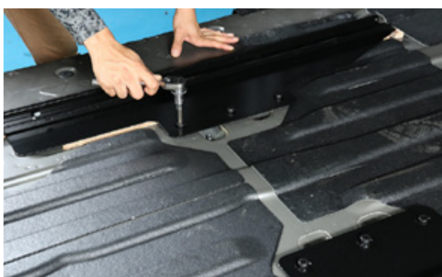
■ 調整が終われば全てのボルトを固定して下さい。 増し締めの際に先程の手順で調整した『幅』がズれる可能性がありますので十分、気をつけて下さい。
