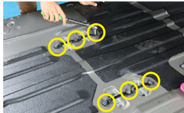
■ 後脚用の純正金具(ボルト片側3本の○印)を取り外して下さい。
