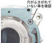
○ケース合わせ面を清掃し、ノックピンと新品のガスケットを取り付け、 カバーを取り付けます。
