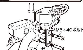
**2** 本体をスペーサー、ワッシャー、M6×40ボルトにて取り付けます。この時マスターシリンダー・スイッチボックス・ミラー等と接触しないよう確認しながら取り付けてください。干渉する場合はスペーサーを2段にしてM6×55ボルトで取り付けます。
