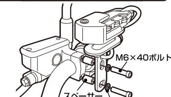
**2** 本体をスペーサー、ワッシャー、M6×40ボルトにて取り付けます。この時マスターシリンダー・スイッチボックス・ミラー等と接触しないよう確認しながら取り付けてください。干渉する場合はスペーサーを2段にしてM6×55ボルトで取り付けます。
