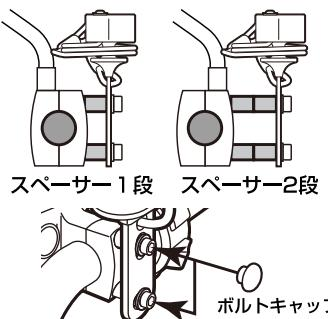
**3** ハンドルを左右に切って製品本体やケーブルがタンクやカウル等との接触が無いかスイッチ類との接触が無いか運転操作に支障が無いかを確認ください。各取り付け部を確認し、最後にボルトの六角穴部にボルトキャップをはめて完成です。
