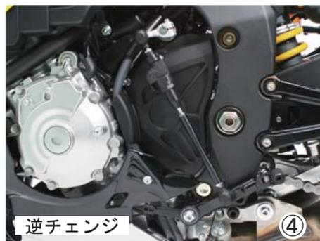
両側ピロボールはチェンジロッドに6mm以上ネジ込んでください。
