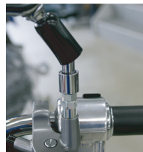
VT400Sのミラー取付部(新車時)。 車両側正ネジ、ミラー側逆ネジのアダプターにダンパー付きアダプターが装着されてブーツで覆われている。
