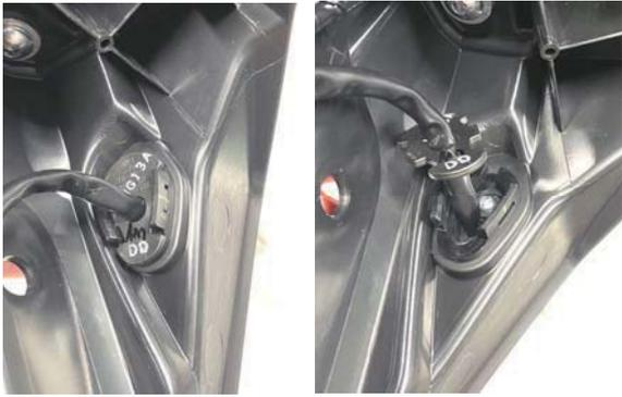
2-5. 分解したリアフェンダーからウインカーを取り外します。
