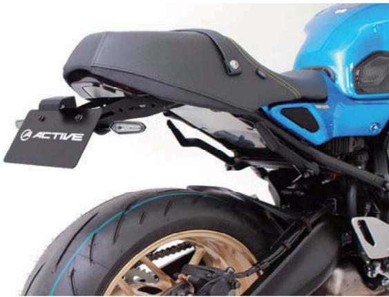
3-7. 全体の位置を確認し増締めし、取り外した外装を取り付けます。
