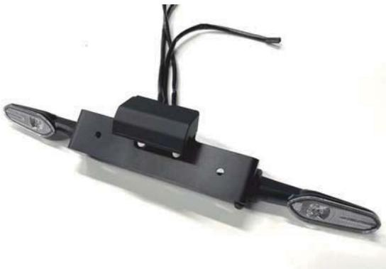
3-1. ③ウインカープレートにナンバー灯とウインカーを取り付けます。
