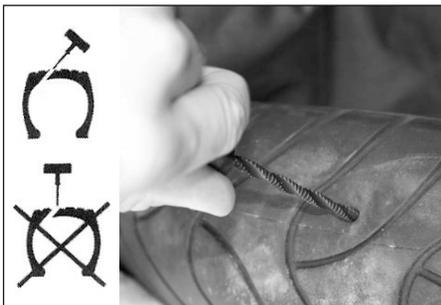
3. Utiliser le poinçon torsadé pour uniformiser et préparer le trou. Limer à plusieurs reprises le trou en allant de l'intérieur vers l'extérieur puis inversement, jusqu'à ce qu'il n'y ait plus aucune résistance.
