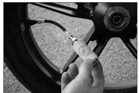
8. La cartouche contient 16g de CO<sub>2</sub> sous pression permettant de gonfler un pneumatique en 180/55-17 à 2,18 bar. Lorsque la cartouche est vide dévisser le raccord flexible de la valve sans dévisser la cartouche (sinon le pneu se dégonfle). Revisser le bouchon de valve assurant la bonne étanchéité de l'obus.
