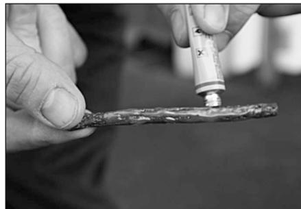
4. Appliquer la colle sur une mèche avant de l'introduire dans le pneumatique.
