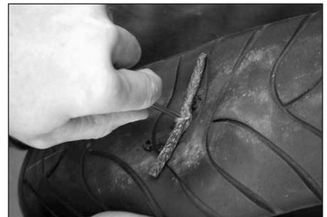
5. Utiliser le poinçon porte-mèche en plaçant la mèche pré-collée au milieu du crochet. Introduire le poinçon avec la mèche puis effectuer un quart de tour avant de retirer le poinçon délicatement.
