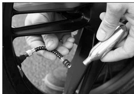
7. Positionner la roue de façon à ce que la valve soit décalée de la zone de contact du pneu avec le sol. Visser le raccord flexible fourni sur votre valve (attention au sens). Utiliser la protection thermique en mousse autour de la cartouche. Visser la cartouche de CO<sub>2</sub> sur l'extrémité du raccord comportant le biseau qui permettra de percer celle-ci.
