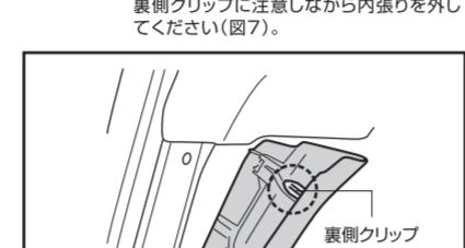
④Cピラー部及びDピラー部(リアハッチ側)のカバー上部を外す。天井の内張りがずらしやすくなります(図6)。
