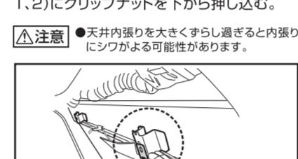
クリップナットのナット部が車両側ステーの向こう側に入る向きで押し込んでください(図4)。
