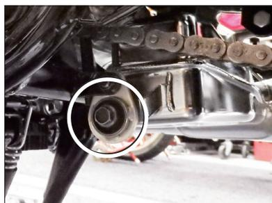
車体左側(ドライブチェーン側)のサイレンサーボディー固定箇所(ダンパーゴムの間のツバ付きカラー)もあとで抜き取っておきます。
