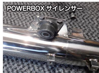
この時点で本締めしておきます。(車体組み込み後に本締めしようとする、お手持ちの工具によっては工具が届かない場合があります。)
