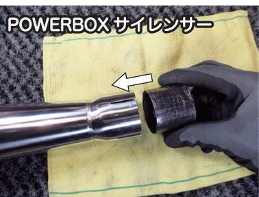
ジョイントガスケットは基本的に再使用しますが、固着して取れなかったり、著しく傷んでいる場合にはSR400専用サイズの物を別途ご購入の上新品に交換して下さい。
