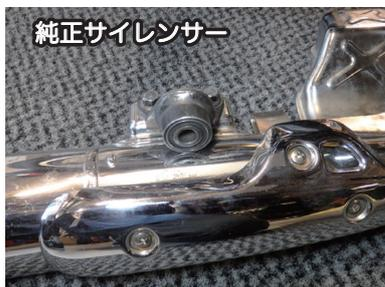
純正サイレンサー上部のステーを取り外し、POWERBOXサイレンサーに取り付けます。
