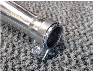
エキゾーストパイプとの接合部のバンドとボルトは再使用します。かなり緩い状態で組み付けておきます。
