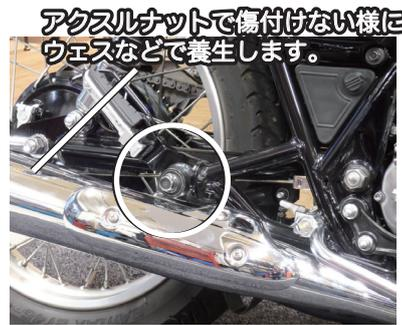
サイレンサー上部を固定しているボルトを抜き取り、サイレンサーボディーを上下左右に小刻みに揺する様にしてエキゾーストパイプからゆっくりと取り外します。
