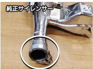
サイレンサーのジョイントガスケットは純正サイレンサーから取り外して再使用します。固着して取れなかったり、著しく傷んでいる場合には専用の物を別途お買い求めの上交換して下さい。あらかじめグリスを薄く塗ってから差し込むと滑りが良くなり、ガスケットを傷めずに入れ易くなります。
