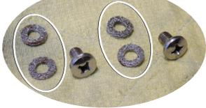
純正サイレンサーのプロテクターを固定している⊕スクルーの内側に使われているワッシャープレートを4枚再使用します。
