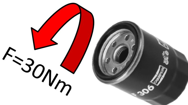
Bei diesen Ölfiltern kann es zu Undichtigkeiten kommen, wenn das Anzugsmoment überschritten wird. Wie bei vielen Ölfiltern üblich, sind die Werte relativ gering – für diesen Filter darf das Drehmoment nicht mehr als 30 Nm betragen.
