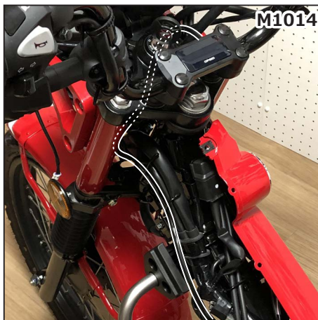
メーターコードをトップブリッジ下からバッテリー付近までメインハーネスに沿わせていきます。 Run meter wire along main harness from top bridge to near battery.
