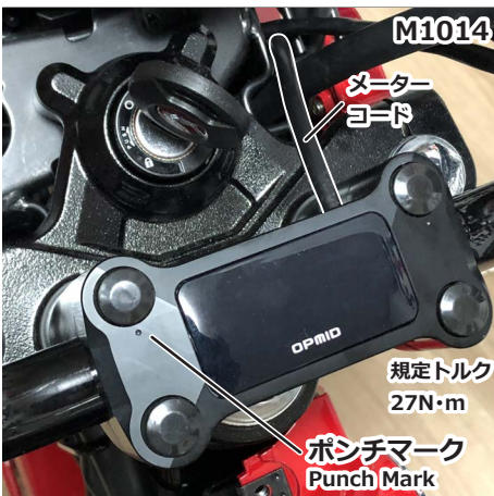
⑧ アッパーホルダーのポンチマークを前方に向け、純正ソケットボルト4本を再利用して取り付けます。ポンチマーク側のボルトから締め付けます。キーシリンダーの右側にあるブレーキスイッチコードのガイドにメーターのコードを通します。 With punch mark facing forward, reuse 4x genuine socket bolts to attach. Tighten bolt on punch mark side first.
