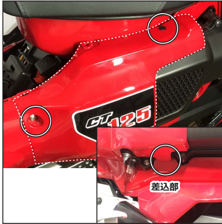
スクリュー1本とトリムクリップ（短）1本を外し、エアクリーナーガーニッシュを外します。 ※下部に差込部があります。 Remove 1x screw and 1x trim clip (short) , and remove air cleaner garnish.
