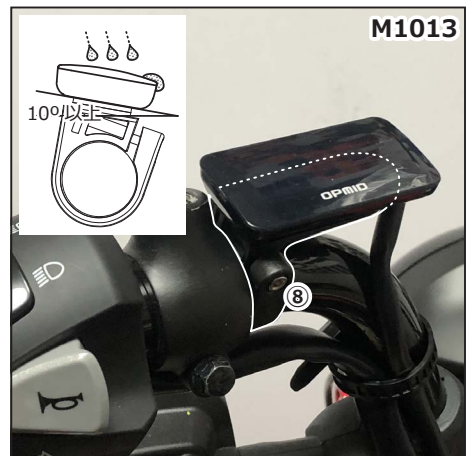
⑧ ハンドルバーブラケットをハンドルに通し、ネジを締め固定します。パネルに水がたまるのを防ぐために、水平より10度以上傾けて固定してください。 Through ⑧ Handlebar bracket to handle, and fasten screw. Please tilt more than 10 degrees to prevent water accumulation on panel.
