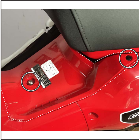
1本のスクリューとトリムクリップ（長）を外し、センターカバーを外します。 Remove 1x screw and 1x trim clip (long) and remove center cover.
