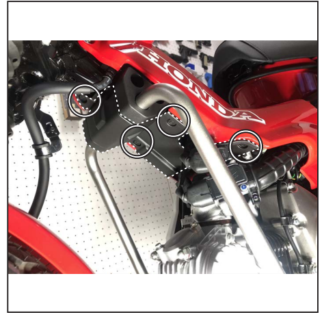
トリムクリップ（短）を4本外し、メインパイプロアカバーを外します。 Remove 4x trim clips (short) and remove Main pipe lower cover.
