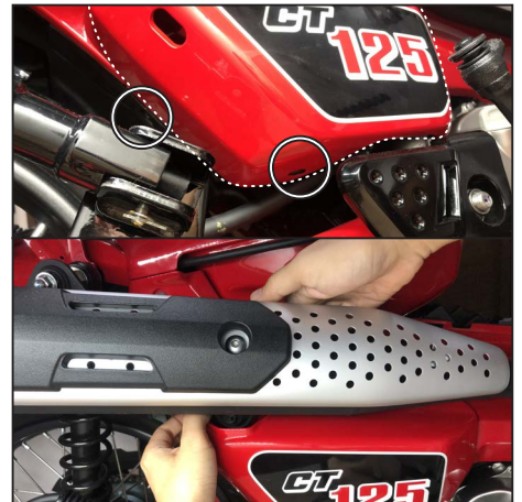
スクリュー1本と、トリムクリップ（長）1本を外し、右ボディカバーを外します。 ※後方から順にロックを外していきますが、新車時はとても硬いです。カバーを外さず下の隙間から作業することも可能です。 Remove 1x screw and 1x trim clip (long) and remove right body cover.
