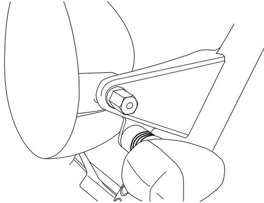
3. ②取り付けステーをアンダーブラケットに装着します。ボルトは純正ボルトを使用して装着します。
