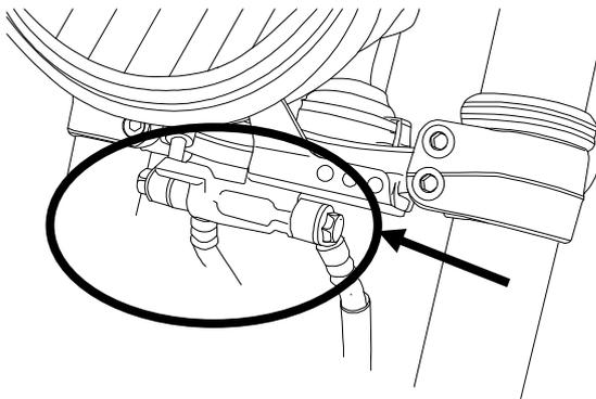
(2) 右図の矢印部分のボルトを外します。
