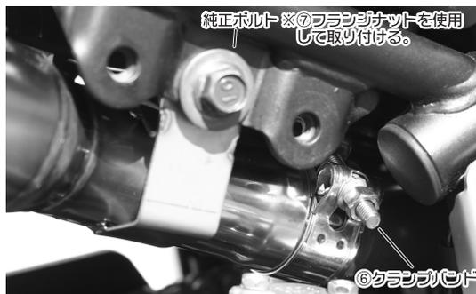
5. サイレンサーを取り付けます。純正ボルトを
