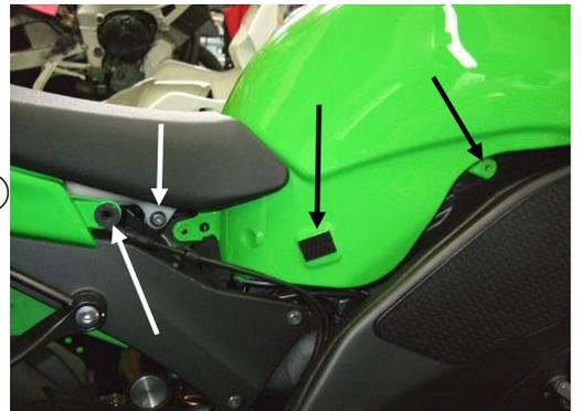
8) 写真① 矢印範囲内のサイドカバー、カウルは、フレームカバーとのクリアランスがないので、付属のフチゴムを適当な長さに切って付けてください。
