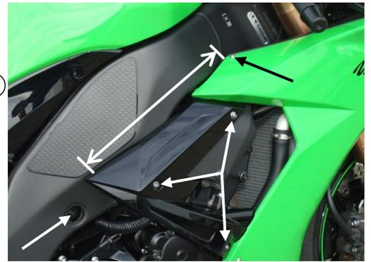
2) 写真① 矢印4箇所ビスを外し、サイドカバーを取り外します。左側は、写真② 矢印部2箇所のボルトも外し、リザーブタンクをフレームから浮かせます。
