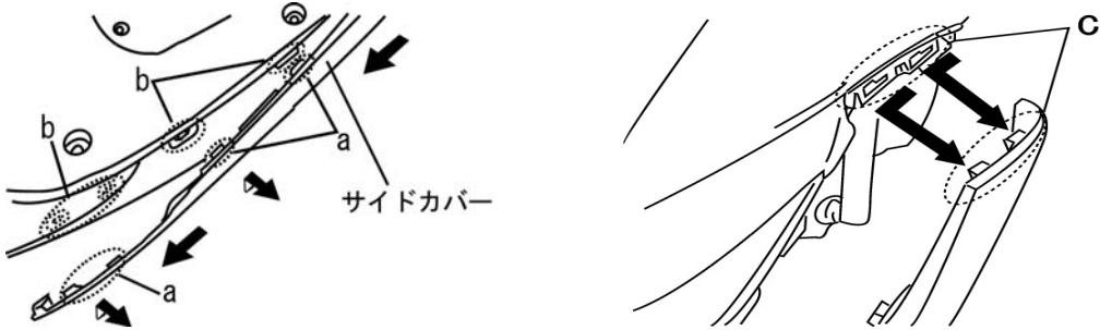
2. 下図を参考にシート側より純正トルクスネジ①（2ヶ）と純正ビス②③（各2ヶ）、前側より純正ネジ④（3ヶ）と純正ブッシュリベット⑤（2ヶ）を外し、ツメの破損に注意しながら純正フロントカバーを車体から取り外します。
